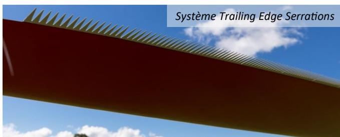
Pour le projet éolien d'Avosnes et Saffres, les éoliennes utilisées seront à la pointe de la technologie. Ainsi un système appelé TES (Trailing Edge Serrations), encore appelé « peignes », composé de « dentelures », pourra être mis en place sur les pales des éoliennes, pour réduire les bruits d'ordres aérodynamiques.
